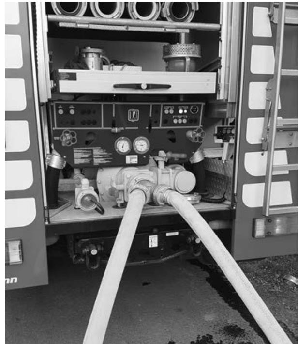
*Aus dem Hydranten wird das Wasser mit zwei B-Schläuchen zur Pumpe im Fahrzeug befördert. Von dort wird es dann zu den Strahlrohren gepumpt.*
